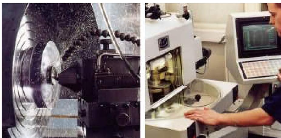
Рисунок 21.5 СЛЕВА: Алмазно-токарный механизм; СПРАВА: Полирование линз
