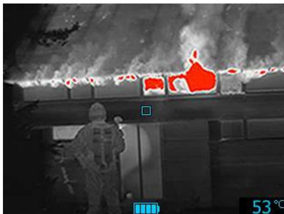
**Рисунок 19.10** Режим обнаружения тепла.
