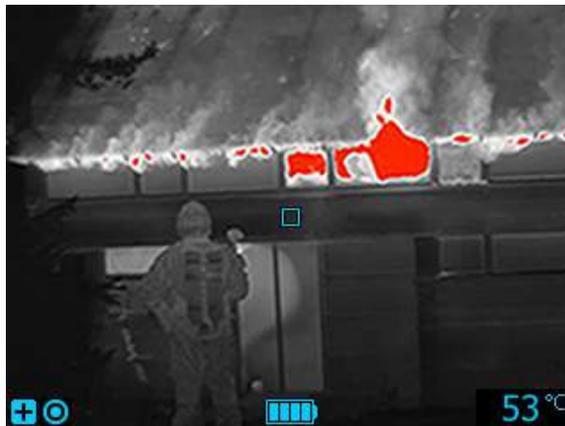
**Рисунок 19.5** Режим обнаружения тепла.
